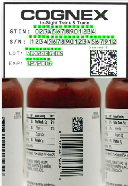
Lectura y verificación de código datamatrix y OCR
